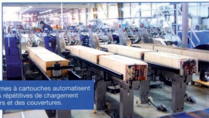
Les systèmes à cartouches automatisent les tâches répétitives de chargement des cahiers et des couvertures.
