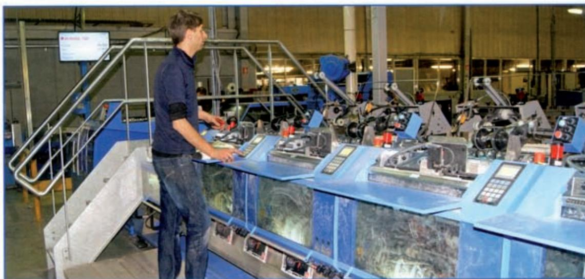
L'encarteuse-piqueuse Primera se caractérise par sa cadence élevée de 14 000 cycles à l'heure et par ses temps de réglage courts.
