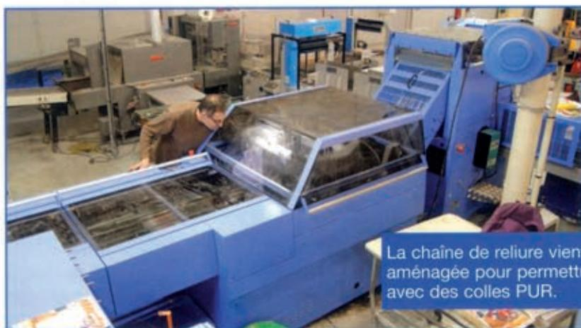
La chaîne de reliure vient d'être aménagée pour permettre la reliure avec des colles PUR.
