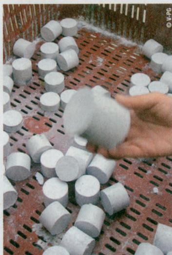
A la sortie de l'imprimerie, le broyeur compacteur de papier recrache des "cachets" concentrés.
