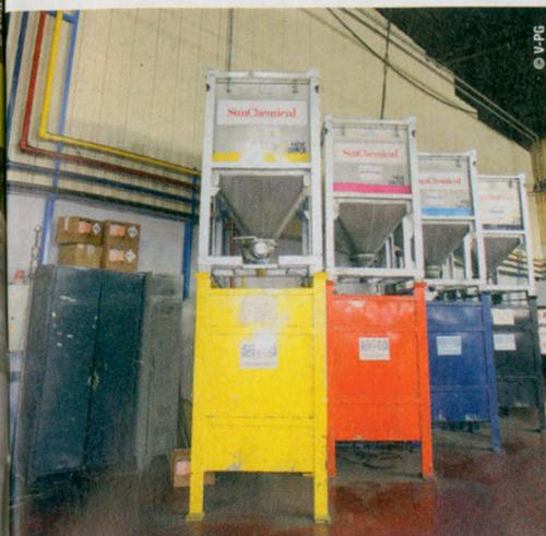
L'alimentation en encre se fait de façon automatique avec de gros fûts. Cela limite le contact avec les produits et évite la multiplication de boîtes vides.
