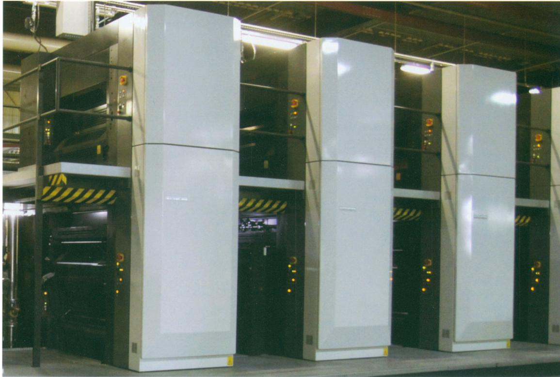
Unité de production phare du Groupe des Imprimeries Morault, l'Imprimerie de Compiègne a franchi une nouvelle étape en mars dernier : elle s'est dotée d'une rotative 32 pages Komori LR-438/1250D 4 groupes, équipée d'un nouveau module permettant de réaliser 8 produits de 4 pages ou 4 produits de 8 pages par tour machine.
