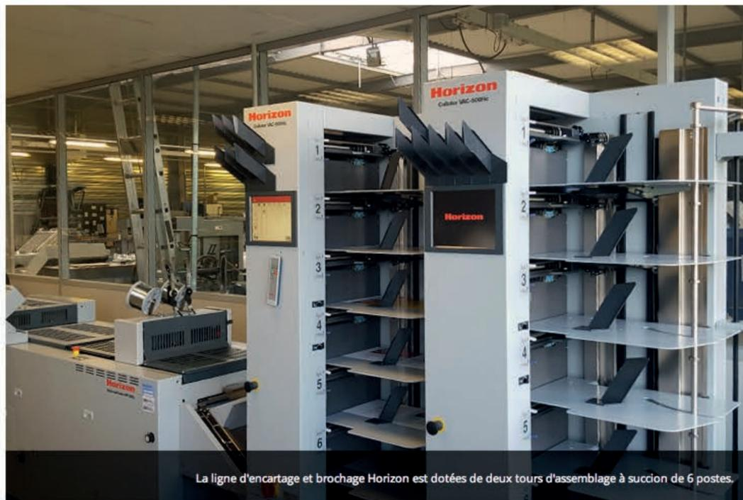
La ligne d'encartage et brochage Horizon est dotée de deux tours d'assemblage à suction de 6 postes.
