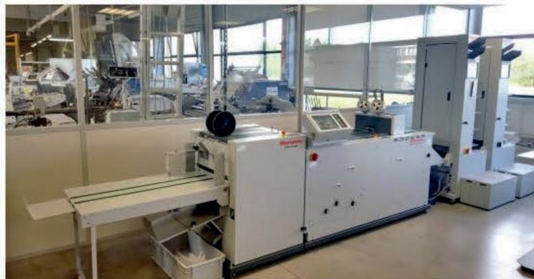
Le massicot coupe de chasse robotisé FC-200L gère des formats jusqu'à 356 x 610 mm.
