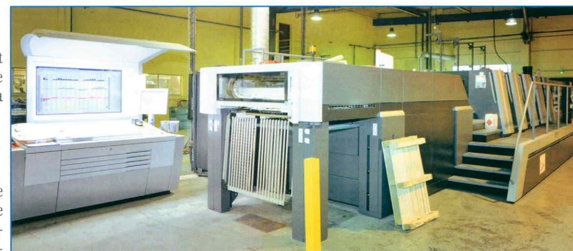
Installée l'été dernier, la nouvelle presse Heidelberg XL 106 bénéficie du dispositif de mesure et de régulation de l'encrage et du repérage Inpress Control, et de l'écran mural Wall Screen, qui donne aux opérateurs une vision intégrale de tous les processus de l'impression.
